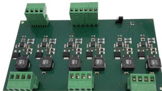
**Driver 6 CANALI a corrente costante per alimentazione illuminatori a power e midle power led**
